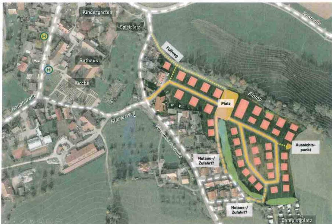
**Abbildung 2:** Der erste Testentwurf der fsp.stadtplanung zeigt die Zuwegung und einen möglichen Straßenverlauf im neuen Baugebiet. Orange hervorgehoben sind geplante Fahrstraßen, gelb gepunktet geplante Fußwege.
